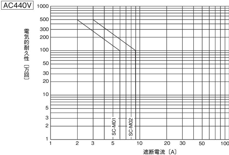
■AC-4 遮断電流と電氣的耐久性曲線
