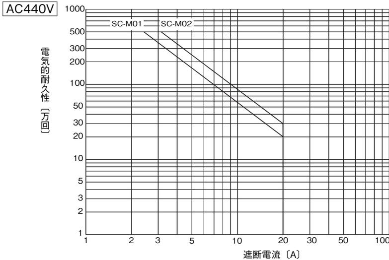
■AC-3 遮断電流と電氣的耐久性曲線
