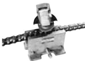
図3. ピンの端部を削る
