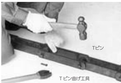
写真は、Tピンを真直ぐにした後で抜いています。
