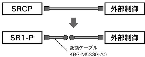
SRCPでご使用していただいたシステムをSR1-Pに変更する時に、SRCP用のコネクタをそのまま接続できる変換ケーブル。
