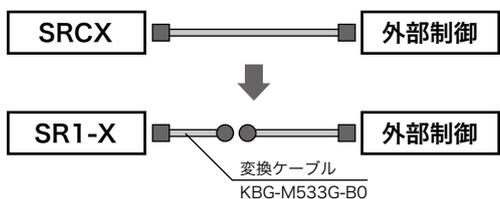
SRCXでご使用していただいたシステムをSR1-Xに変更する時に、SRCX用のコネクタをそのまま接続できる変換ケーブル。
