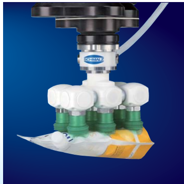
ベローズパッドを6個組み合わせた VEEによるパウチ袋の搬送
