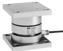
オールステンレス溶接密閉構造で揺動機構型。スッパ一金具付。食品、薬品市場でホッパ、タンクスケールに最適。圧縮タイプ。玉受機構により横荷重を受けた場合、復元力が得られる機構です。
