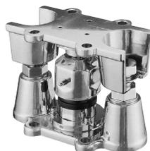
オールステンレス溶接密閉構造(IP68)で屋外や悪環境下での使用も可能。取付金具一体型。振れ止め・浮上がり防止機構一体型で取付作業が簡単。軽量・高性能。総合誤差0.03% R.O.の高精度。
