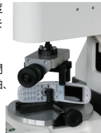
携帯電話の開閉 トルク測定
