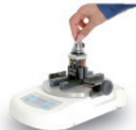
キースイッチの トルク測定
