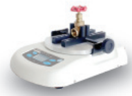
バルブの開閉 トルク測定
