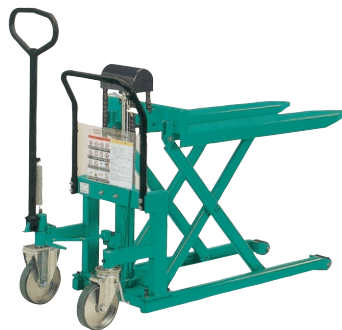
足踏みポンプは安全でコンパクトな折りたたみ式 (LV50、LV100共通)
